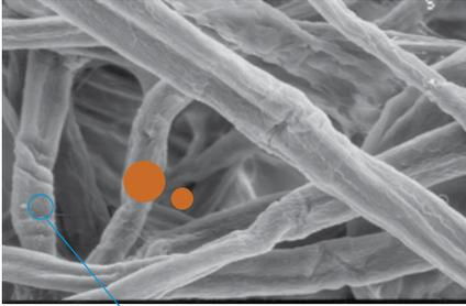
Les fibres de cellulose sont plus épaisses et l'espace entre ces fibres est plus important. C'est pourquoi les contaminants sont capturés en profondeur par le matériau et bloquent la circulation de l'air. Le flux est alors davantage restreint et la capacité moindre.
