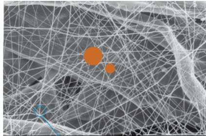
Les fibres du matériau de filtration présentent un diamètre inférieur au micron et un espacement entre les fibres réduit.
